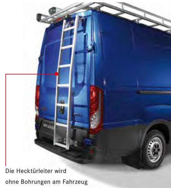
Die Hecktürleiter wird ohne Bohrungen am Fahrzeug befestigt.
