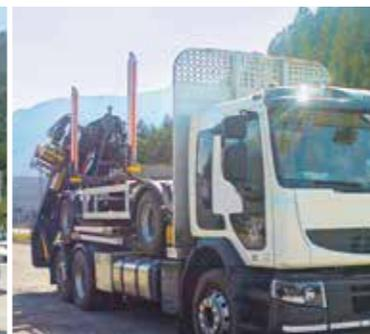
Ein Beispiel für die Sonderlösungen „Made by Notterkran“: die Möglichkeit, den Anhänger mithilfe des aufgebauten Krans auf den Lastwagen zu setzen. Das Ergebnis: eine deutliche Kosteneinsparung bei der LSVA und schnellere Ankunft am Arbeitsort.
