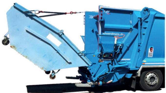
Seilwinde für 5m<sup>3</sup> Mulden
