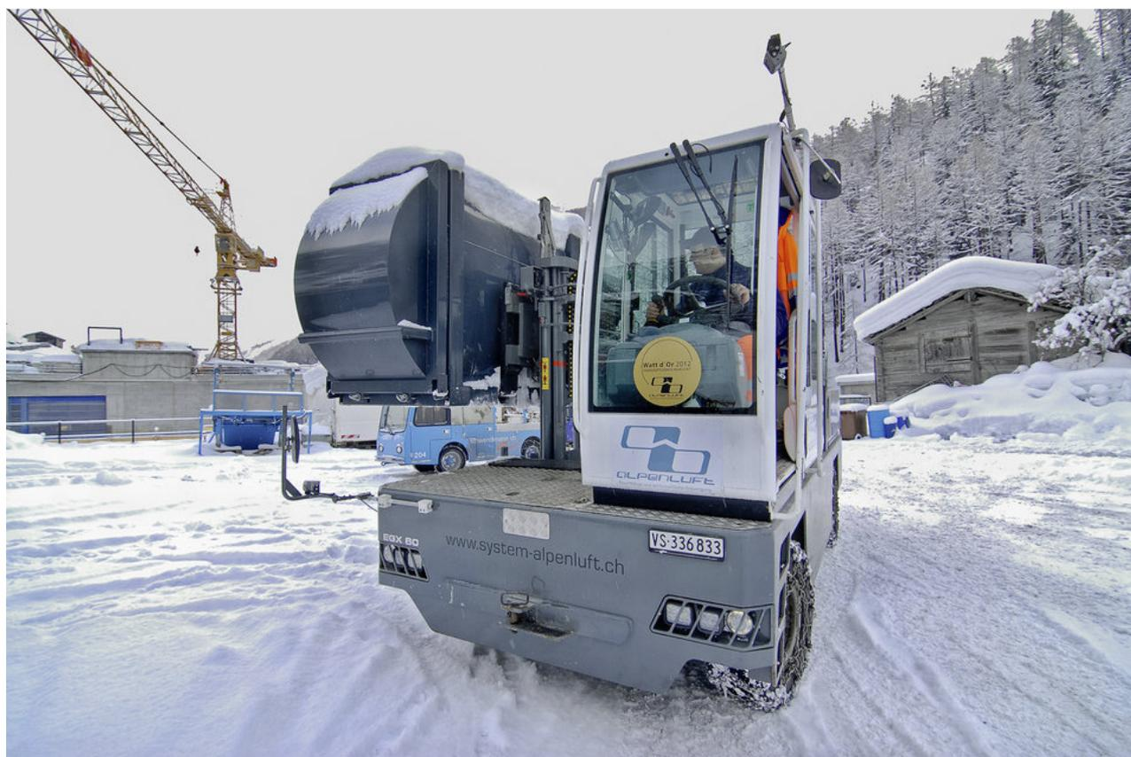
**1/3**Die seitliche Staplergabel ausfahren, den Container anheben und auf die Ladefläche stellen – das elektrische Kehrlichfahrzeug im Einsatz.
