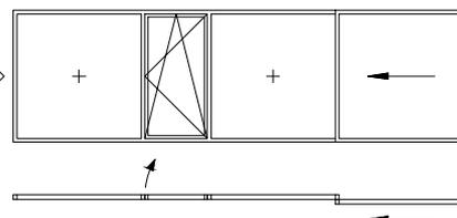
Das air-lux Fassaden-Fenstersystem ist eingleisig, der Schiebeflügel fährt aussen vor der Festverglasung.
