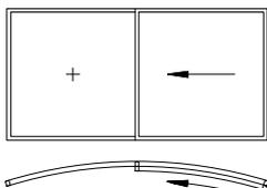
Schieber Mitte (Innenbogen) (Vertikalstoss Ganzglas)
