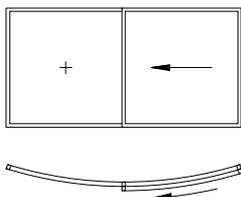
Schieber Mitte "Aussenbogen" (Vertikalstoss Ganzglas)
