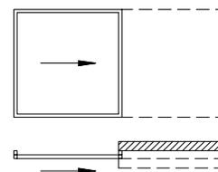
Schieber Mitte (Vertikalstoss Ganzglas)
