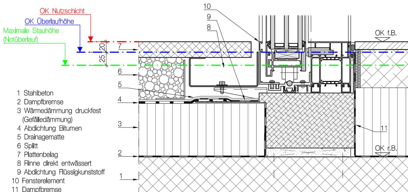
Variante B (Entwässerung über Nutzschicht)
