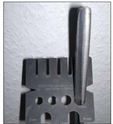
Paßt die Klinge durch das entsprechende Loch, so unterschreitet ihre Breite die Vorgabe; hier ist zumindest die Klingenspitze schmaler als 10 mm.
