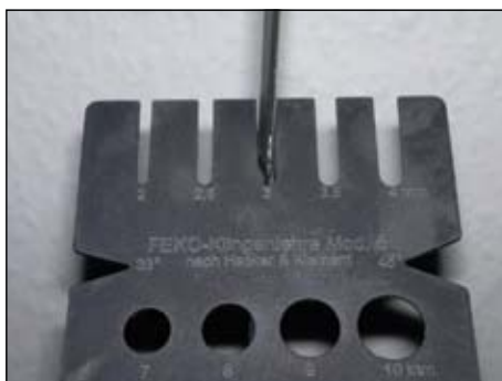
Mehrere Meßmöglichkeiten der Klingenbreite je nach Commentvorgabe: Paßt sie in den 3-mm-Schlitz, ist sie dünner.
