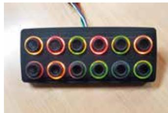
Es wird das gleiche Steuerungsmodul wie bei MULTILIFT verwendet, das sich durch hohe Robustheit auszeichnet. Es verfügt über 8 Eingänge und 8 Ausgänge, ist CAN-Bus basierend, frei programmierbar und durch eine Abdeckung geschützt.
