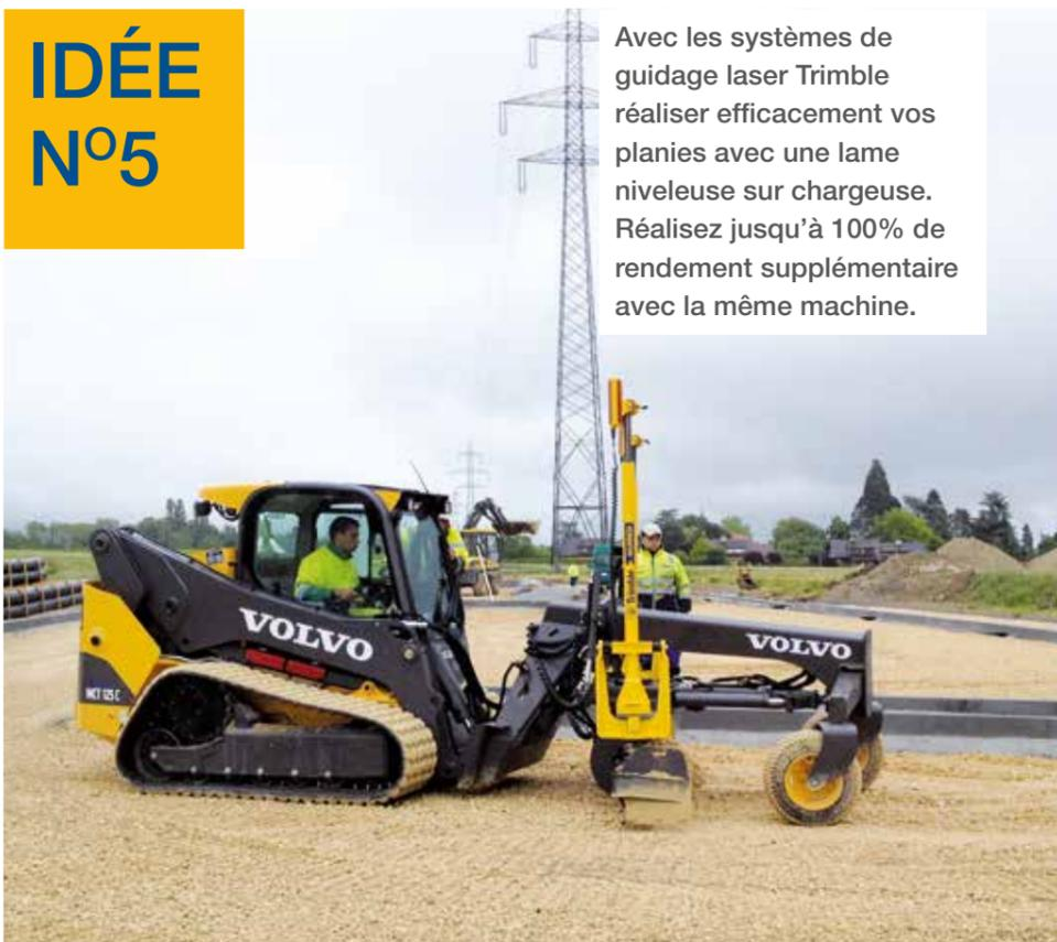
Avec les systèmes de guidage laser Trimble réaliser efficacement vos planies avec une lame niveleuse sur chargeuse. Réalisez jusqu'à 100% de rendement supplémentaire avec la même machine.
