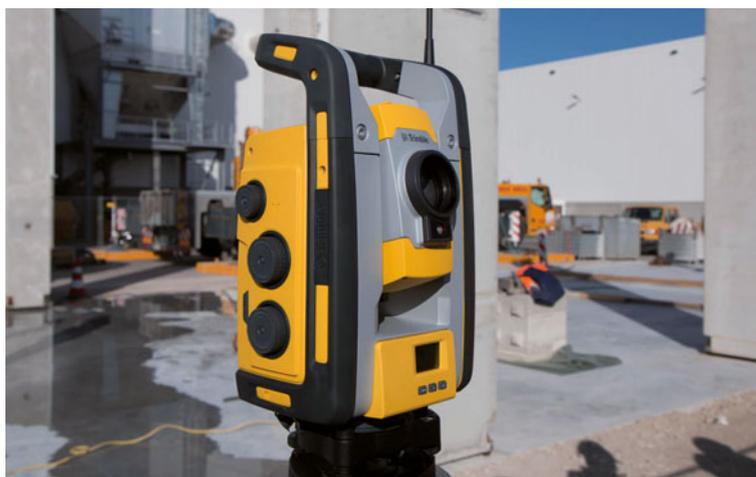
Die Trimble Robotic Totalstation RTS für Einmann-Absteckung im Hochbau und Verarbeitung von BIM-Daten aus CAD-Systemen (Alexander Haag, BuildingPoint AG Schweiz).
