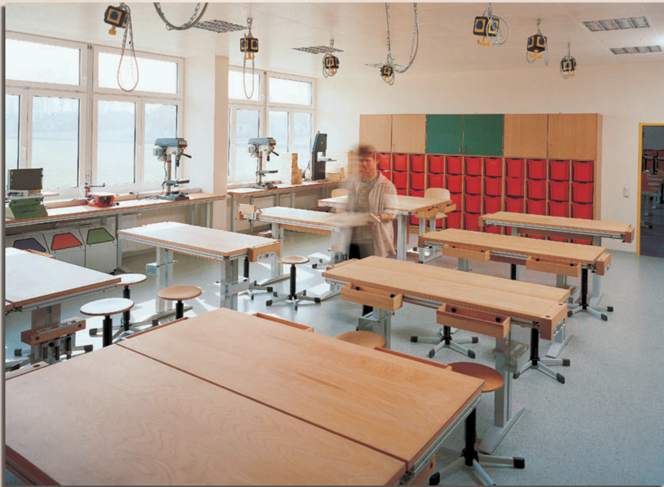
Der „WeVario-Werkraum“ im eingerichteten Objekt: Schüler-Arbeitsplätze mit angeflanschten Aufbewahrungsladen für Werkzeuge und Kleinteile. Reihen-Werkbank an Fensterfront mit aufgebauten Maschinen.
