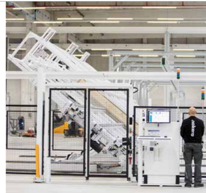
Die Fertigung der Wandelemente verläuft ausschließlich automatisiert.
