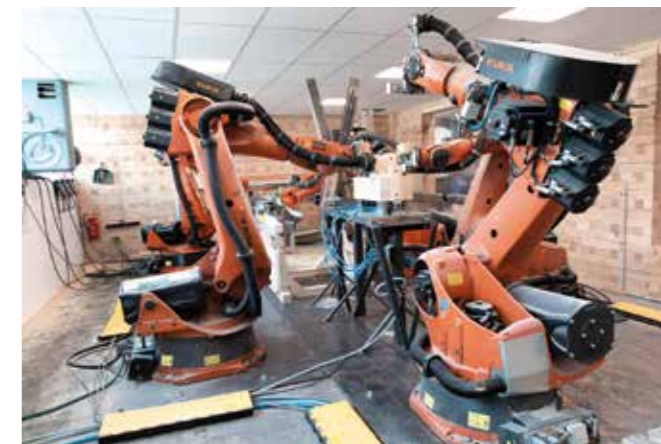
Die einzelnen Holzbausteine werden von Robotern gefertigt,
