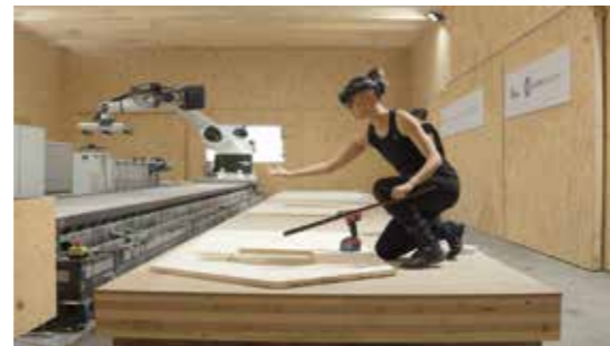
Mensch-Maschine-Interaktion über die AR-Brille für die Teilmontage von Sonderbauteilen.
