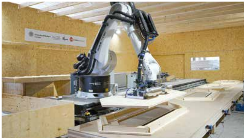
Mensch-Maschine-Interaktion über die AR-Brille für die Teilmontage von Sonderbauteilen.
