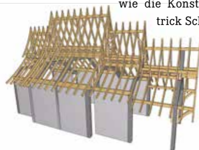
Technische Zeichnung von Patrick Schötz von der neuen Dachstuhlkonstruktion.
