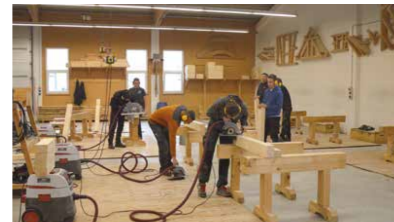
Zuschneiden der Holzelemente: Dachstuhlbau in Theorie und Praxis gehört zum Ausbildungsplan.
