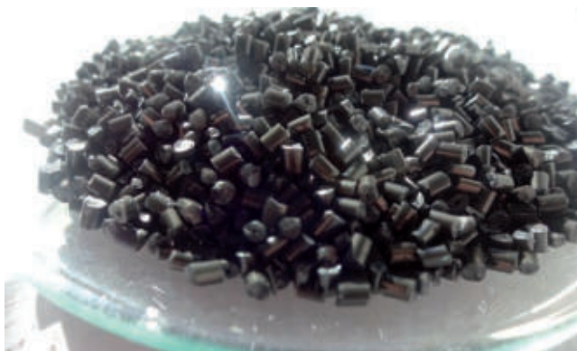
So sieht das gewonnene Basisgranulat aus recycelten EPS-Dämmstoffen aus.
