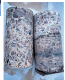
Zwei Bohrkern aus Stahlbeton
