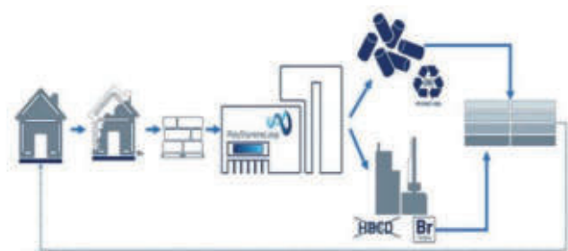
Recyclingprozess der EPS-Dämmstoffe von der Sanierung bis zum neuen Produkt.
