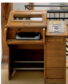
Ein Fernschreiber übermittelt Nachrichten in Schriftform mittels elektrischer Signale.
