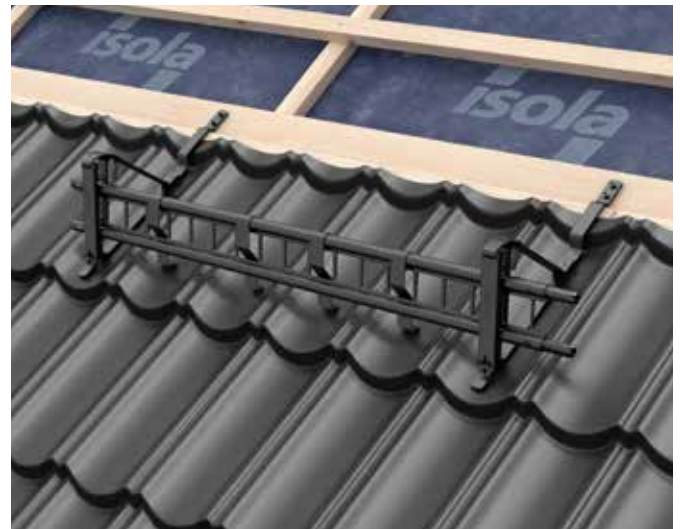
Schneefanggitter mit Schneefangstützen und vier Eisstoppfern, die das Durchrutschen von Eis und Schnee unterhalb des Gitters verhindern.
