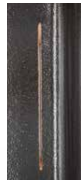
AkkuMAX -Schnittbreite bei Ø 230 mm: ca. 1,76 mm
