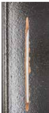
Standard-Schnittbreite bei Ø 230 mm: ca. 3,2 mm
