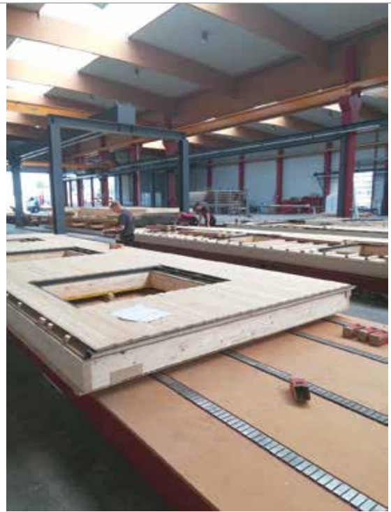
Die mächtigen Holzwände können auf den höhenverstellbaren Arbeitstischen Schritt für Schritt vorgefertigt werden.
