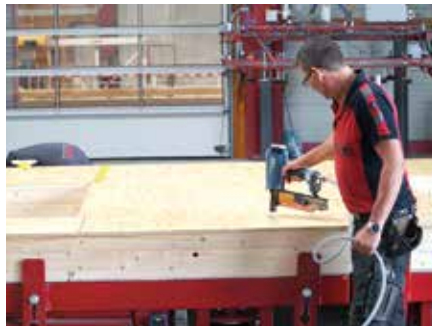
Die mächtigen Holzwände können auf den höhenverstellbaren Arbeitstischen Schritt für Schritt vorgefertigt werden.
