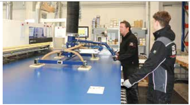
Rund 100 Kilogramm wiegt die Platte vor der Bearbeitung. Das Bearbeitungsprogramm hat vor dem Zuschnitt den geringsten Verschnitt errechnet.
