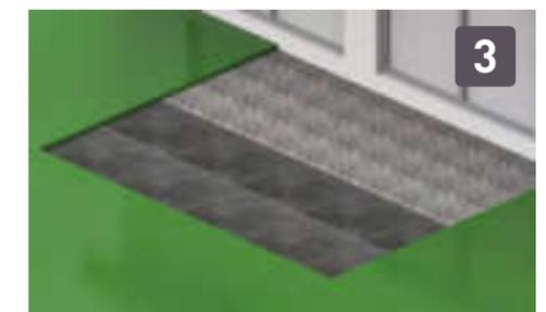
3. Auf diese Tragschicht kommt eine rund drei bis fünf Zentimeter starke Bettungsschicht aus Splitt 2/5 Millimeter. Optional können Sie ein Wurzelvlies gegen Unkrautbewuchs verlegen. Achten Sie darauf, dass die Bahnen rund zehn Zentimeter überlappen.
