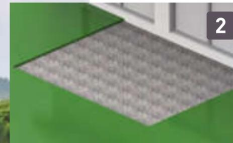
2. Für den Untergrund gilt ein wasserdurchlässiger Bodenaufbau nach DIN 18130-1 und 18533. Optimal ist beispielsweise eine zirka 15 Zentimeter starke Tragschicht (Körnung 0-45) ohne Bindemittel (Nutzungsklasse N1 nach der ZTV-Wegebau).
