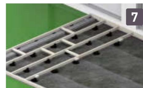
8. Danach werden die zwei parallelen Unterkonstruktionshölzer mit kurzen Stichhölzern der gleichen Ausführung als sogenannte Leiter verschraubt. Die Stellfüße müssen versetzt angeordnet werden.
