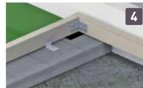
5. Bei der Verwendung von Verstellfüßen müssen Sie immer eine ausgesteifte Rahmenkonstruktion herstellen. Mit kurzen Querhölzern die zirka zehn Millimeter tiefer montiert werden, ist dies einfach umzusetzen. Die Querhölzer können Sie mit Winkeln oder direkt verschrauben.
