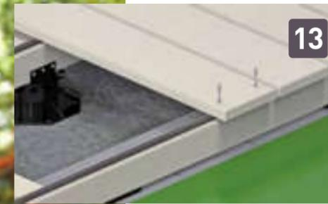
13. Achten Sie auf einen Überstand der Terrassendiele über die zwei äußeren Unterkonstruktionen von etwa 10 bis 20 Millimetern. Pro Diele müssen mindestens zwei Verschraubungen auf jeder Unterkonstruktion erfolgen. Der Abstand der Schrauben liegt bei zirka 100 Millimetern bei einer Dielenbreite von 145 Millimeter.
