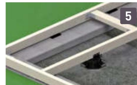
6. Die Verstellfüße müssen Sie nach den Vorgaben der Hersteller an den Unterkonstruktionen anschrauben. Falls die Hersteller keine anderslautenden Angaben machen, überschreiten Sie nicht einen maximal 70 cm Achsabstand in Längsrichtung der Unterkonstruktion.
