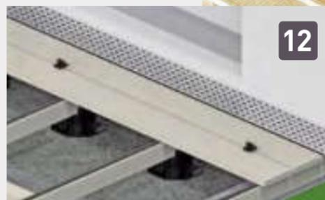
Nennmaß 144 Millimeter + 6 Millimeter Fuge = 150 Millimeter Abstand
