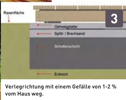
Verlegrichtung parallel zur Fensterfront mit einem Gefälle von 1-2%.
