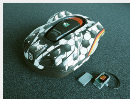
Rasenmähroboter mit Umschaltbox und Senderplatine
