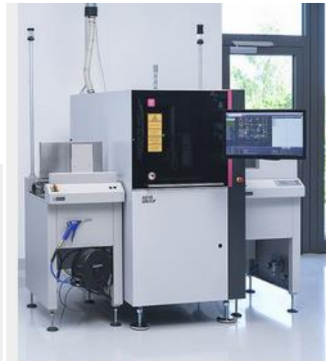
Beschriftungslaser der Firma Asys zur Beschriftung von Leiterkarten in der Braun Industrie-Elektronik
