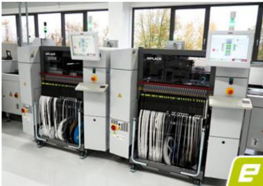
Um effizient und leistungsfähig Bestücken zu können, ist es nötig, mit einer Rüstung verschiedene Aufträge fertigen zu können. Durch die Siplace-Pro Software von ASM werden bei Braun verschiedene Aufträge dahingehend optimiert und durch das Warehouse-Management-System CompControl spurgetreu für die einzelnen Wechseltische aus unserem MLT (Manufacturing Logistics Terminal) ausgegeben.
